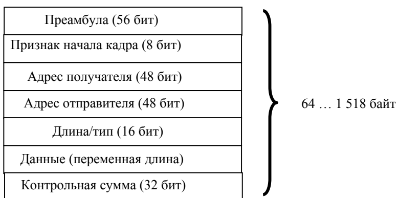
Рис. 1.1. Общий формат кадра Ethernet.
